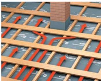
**ВАЖНО!** Необходимо обеспечить свободный проход воздуха в вентиляционном зазоре, для чего обязательно устанавливается разреженная обрешетка поверх контробруса для вентиляционного зазора. Перекрытие мест движения воздуха не допускается. В случае использования дощатого настила в качестве
