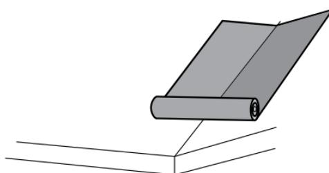
Нахлест АЛЬФА ADEREP на самоклеящийся подкладочный ковер составляет 150 мм, место перехлеста промазывается тонким слоем битумной мастики «ФИКСЕР», толщина нанесения не более 1мм.
