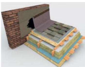
Общий вид бокового примыкания для стены высотой более 1 метра.
