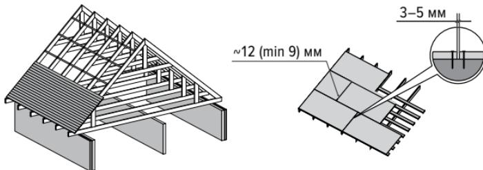
Плиты ОСП-3 можно крепить с помощью шурупов, гвоздей и скоб к деревянным балкам, стропилам, согласно инструкции производителя ОСП плиты. Шурупы для древесины характеризуются нарезкой с большим шагом и хорошо выраженным острием, хвостовик цилиндрический или конический. Диаметр шурупа должен составлять не менее 4,2 мм.
