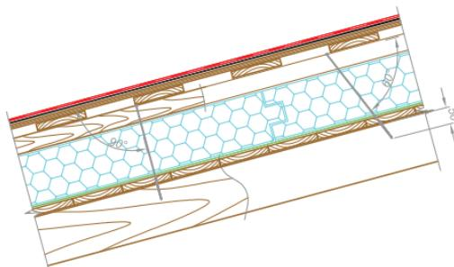
Крепеж нужно подбирать соответствующей длины, чтобы фиксировать одновременно брус для вентиляционного зазора (минимум 50 мм), слой теплоизоляции и заводить его в стропильную ногу минимум на 50 мм.
