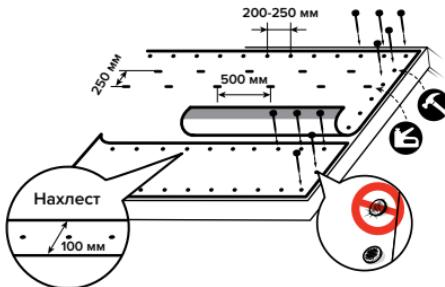
**В зависимости от типа подкладочного ковра произвести его крепление к основанию согласно схемам ниже:**
