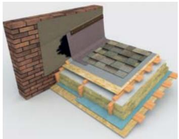
Общий вид бокового примыкания для стены высотой менее 1 метра.
