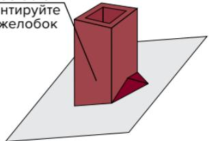
**ВНИМАНИЕ!** Для предотвращения скапливания снега за дымовыми и вентиляционными трубами, если их сечение превышает  $500 \times 500$  мм и они расположены поперек ската, рекомендуется устраивать разжелобок.
