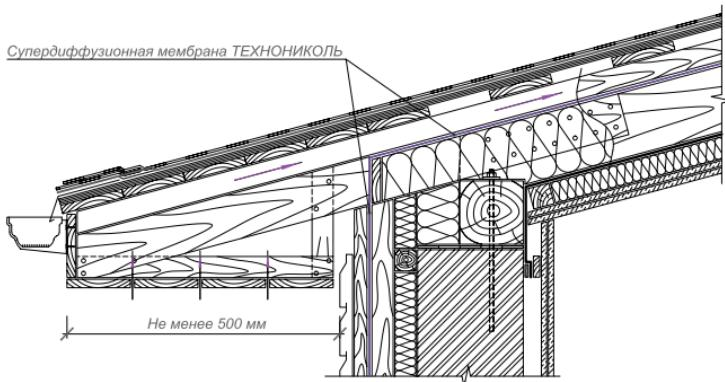
**ВАЖНО!** Воздух должен свободно попадать в вентиляционный зазор и выходить из него. Для этого в районе карниза следует также предусмотреть продухи. Вытяжные системы вентиляции представлены готовыми коньковыми и точечными аэроэле-ментами.
