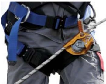
**ВАЖНО!** Для перемещения применяются специализированные страховочные устройства ползункового типа, которые свободно сопровождают кровельщика во время перемещения. Данные устройства автоматически блокируются в случае падения или потери равновесия.
