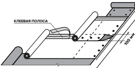
б) При угле наклона кровли от 12° до 18° ширина перехлеста составляет 750 мм, перехлест фиксируется самоклеящейся односторонней лентой АЛЬФАБЭНД 60.
