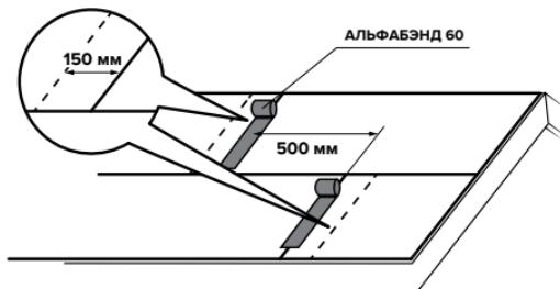
При использовании в качестве временной кровли дополнительно зафиксировать рейками или пятками с шагом 500 см.
