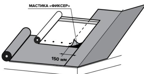
**Внимание!** Допустимо крепить подкладочный ковер АЛЬФА ANDEREP на широкие оцинкованные скобы при одновременном монтаже кровельного покрытия.
