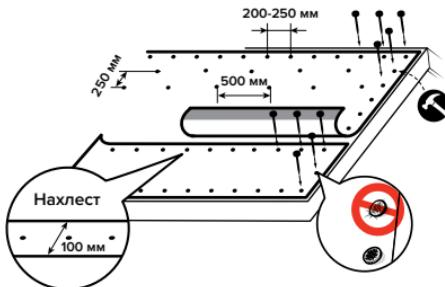
б. монтаж с помощью кровельных ершеных гвоздей и металлических оцинкованных скоб
