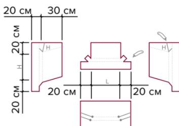
Схема выкройки из ендовного ковра.
