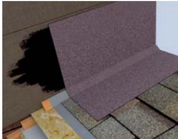
Ендовный ковер приклеивается на битумную мастику по аналогии с устройством прямого примыкания: на праймированную поверхность полоса заводится не менее чем на 300 мм, на рядовую черепицу – 200 мм.
