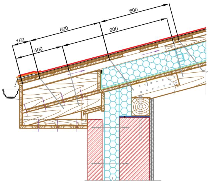
\* Для установки крепежей под 600 можно использовать трафарет-транспортир заводского типа или самодельный.
