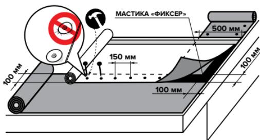
В зоне карнизного свеса: нахлест Альфа ANDEREP на самоклеящийся ковер в зоне карнизного свеса составляет 100 мм, на место перехлеста наносится битумная мастика «Фиксер» на всю ширину перехлеста, толщина нанесения не более 1мм.
