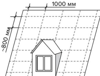
рядовой черепицы, а шаг горизонтальных линий наносится на каждые 5 рядов черепицы (~800 мм).
