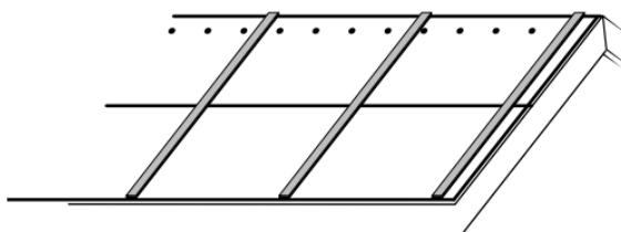
дополнительное крепление подкладочного ковра при помощи реек или пяток с шагом крепления 500 мм.
