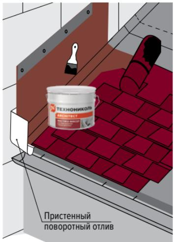
Если скат кровли заканчивается примыканием к стене, то примыкание необходимо выполнить с помощью ендовного ковра, а конце ската установить пристенный поворотный отлив из ассортимента пластиковой водосточной системы ТЕХНОНИКОЛЬ.
